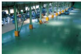
「ユータックA」はアクリル樹脂溶剤形の防塵用塗り床材で、なめらかで光沢のある仕上がりが得られます。また、1液型のため乾燥も速く、ローラーや刷毛などで容易に施工ができます。軽作業所や軽歩行通路、機械室、電気室などに最適な塗り床材です。
