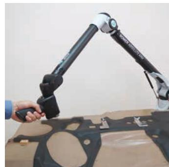
三次元測定機 Coordinate Measuring Machine
